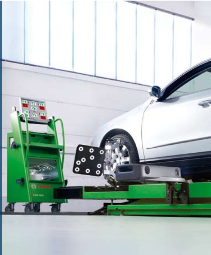
Helppokäyttöinen: autoa ei tarvitse nostaa eikä työntää mittauksen ai
